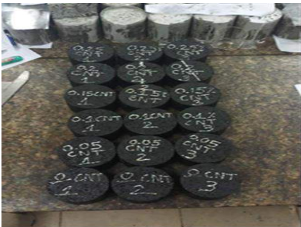
Hình 9. Mẫu thí nghiệm sau chế bị chuẩn bị ép chế
