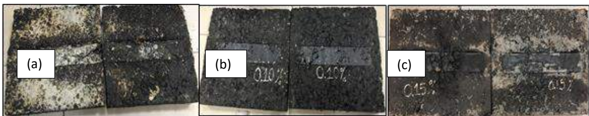
Hình 12. Mẫu sau khi chạy HLVBX: (a) không sử dụng CNTs; (b) 0,1% CNTs; (c) 0,15% CNTs
