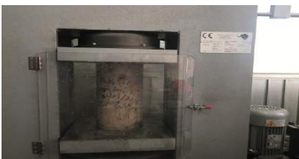
Hình 10. Xác định cường độ chịu nén tại phòng thí nghiệm LAS-XD 143
