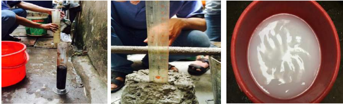
Hình 9. Công tác thí nghiệm hỗn hợp BTXM sử dụng phụ gia \text{SiO}_2
