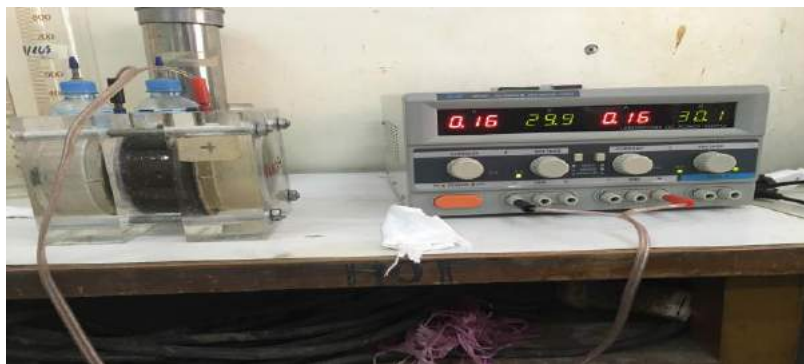
Hình 13. Thí nghiệm xác định độ thấm ion clo bằng phương pháp đo điện lượng
